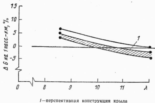
Рис. 3. Изменение расхода топлива на 1 место-км в зависимости от относительного удлинения крыла (дальность полета 5550 км, платная нагрузка 18 140 кгс, крейсерское число M=0,8 , степень двуконтурности 6, \chi=30^\circ , c=0,10 )
